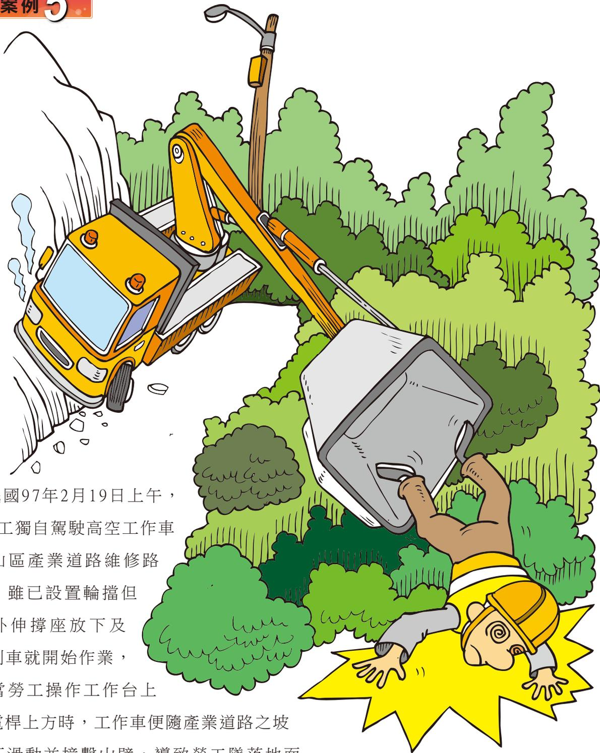
民國97年2月19日上午，1名勞工獨自駕駛高空工作車前往山區產業道路維修路燈時，雖已設置輪擋但未將外伸撐座放下及拉起剎車就開始作業，於是當勞工操作工作台上升至電桿上方時，工作車便隨產業道路之坡度往下滑動並撞擊山壁，導致勞工墜落地面、傷重不治。
