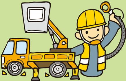
3. 以機具搭載勞工進行高空作業時，應使用高空工作車並設置錨定點或安全母索供勞工掛鉤安全帶；禁止將堆高機做為勞工上下之設備或作業平台。
