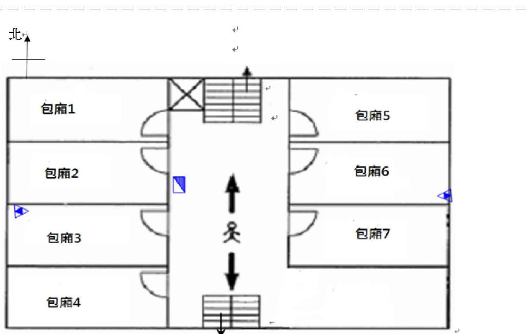
平面圖及逃生避難圖可分別繪製，或合併繪製，另實際製作平面圖及逃生避難圖時，每一樓層均應製。
